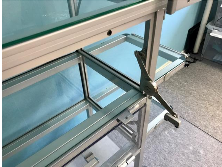
Med luckan öppen, gångjärnen går att ta loss för rengöring. Inga skarvar där smuts kan samlas
