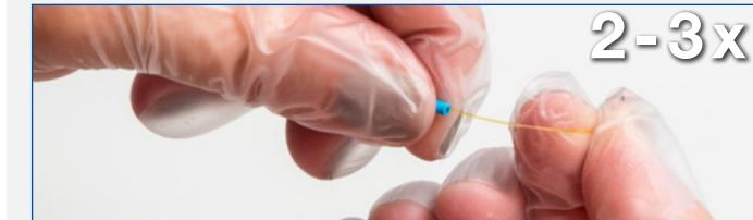
Mit sanftem Druck mehrmals entlang der abisolierten Faser streifen. Hold and strive with a gentle pressure along the stripped fiber.
